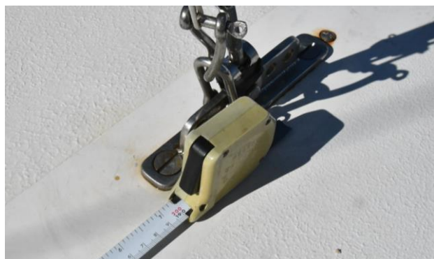
J-målet: 200 cm forkant mast – fokkestaggets skjæringspunkt med dekket er viktig
