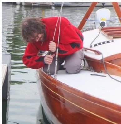
Martin ON109 justerer vantene. Bjørn ON154 retter opp mastetoppen
