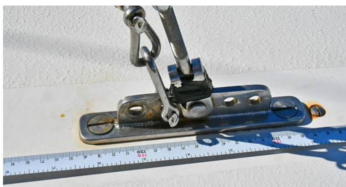
Avstand baugspiss fokkestag påvirker båtens lo/le girighet
