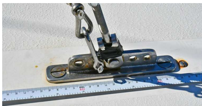
Avstand baugspiss fokkestag påvirker båtens lo/le girighet
