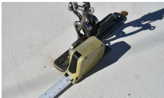
J-målet: 200 cm forkant mast – fokkestagets skjæringspunkt med dekket er viktig
