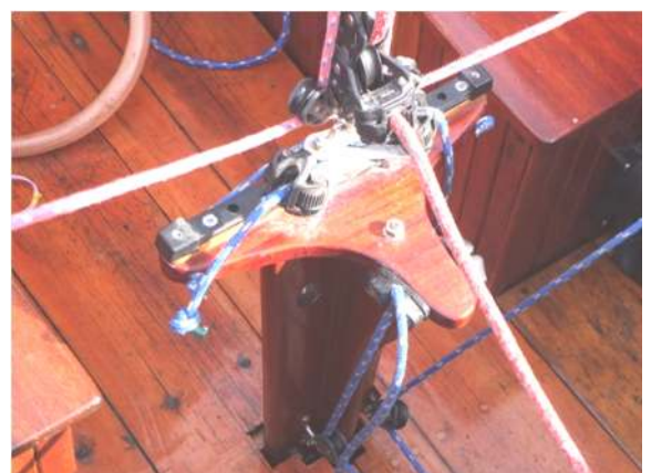
Skjøtestolpe med full kontroll på storseilskjøte, løygang og hekkbardun i ON 11 Inge-Bertin Denne oppfyller kravet i reglene. ref forslag Sak.7.1
