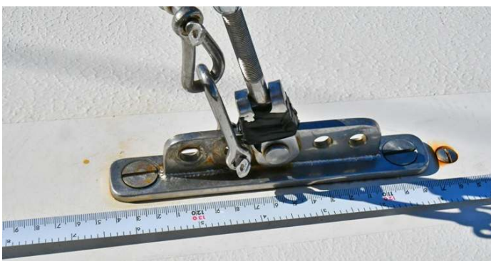
J-målet: 200 cm forkant mast – fokkestagets skjæringspunkt med dekket er viktig
