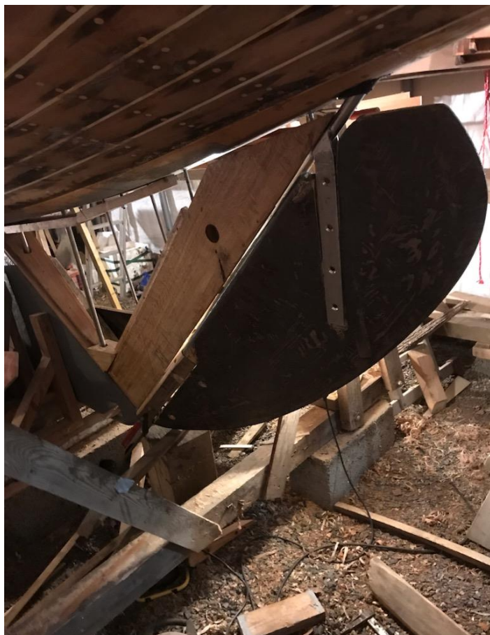
ON 35 Ny rorstokk og ror montert
