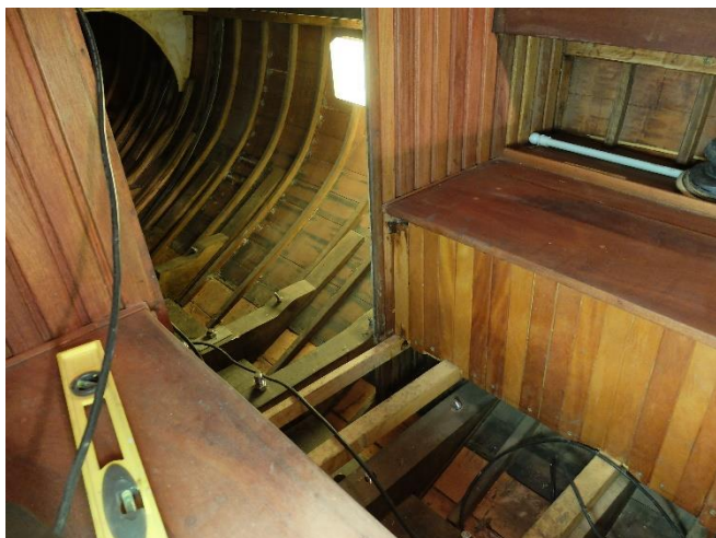
ON 35 Skottet er pusse og nye kistebenker lagd.
