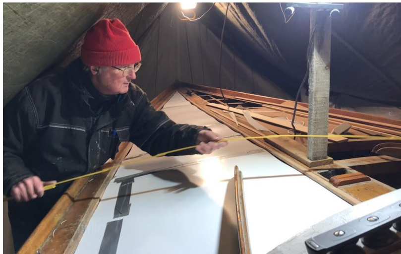
ON 16 Odd Gutteberg legger nytt dekk. Duk og gammelt dekk av pløyde granbord erstattes med 12 mm finer. Foto Inge-Bertin Almeland
