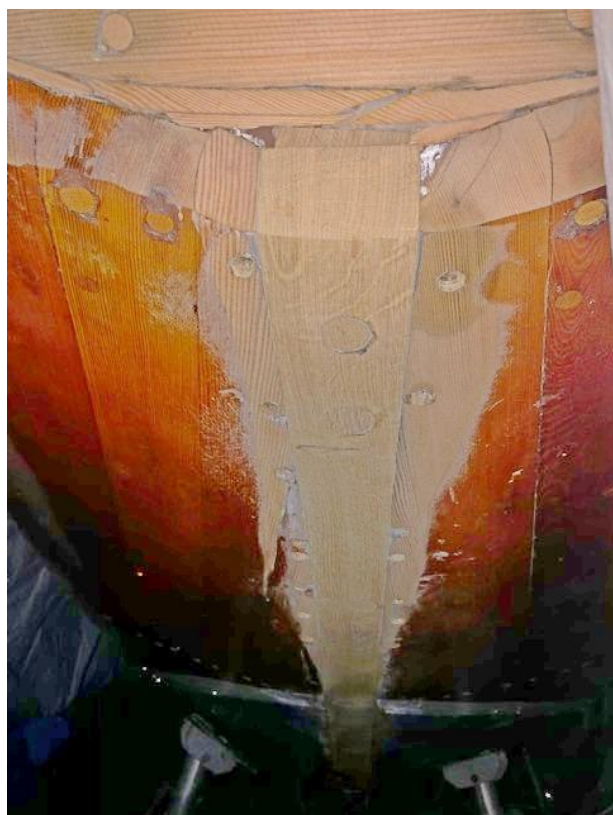
ON 78 Kjølstokk i hekken er skiftet ut. Hele skroget ble pusset ned og fikk ny lakk. Foto Birger Scavenius
