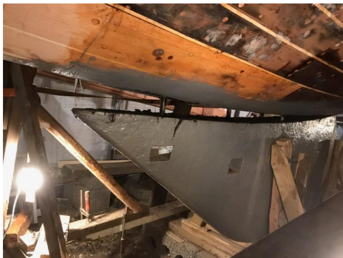
ON 35 Kjølen har vert av for sandblåsing og rustbeskyttelse og monteres med nye kjølbolter.
