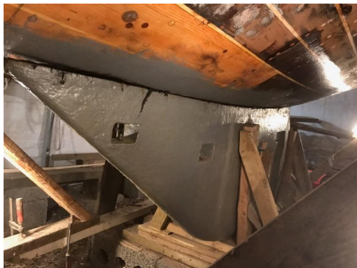
ON 35 Kjølen har vert av for sandblåsing og rustbeskyttelse og monteres med nye kjølbolter.
